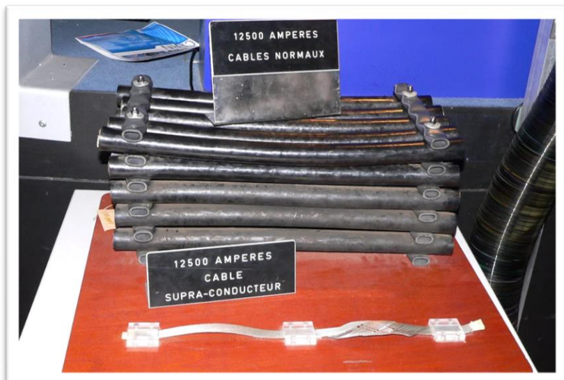
Obraz 12 – porównanie klasycznych przewodów z przewodem stworzonym z nadprzewodnika.
